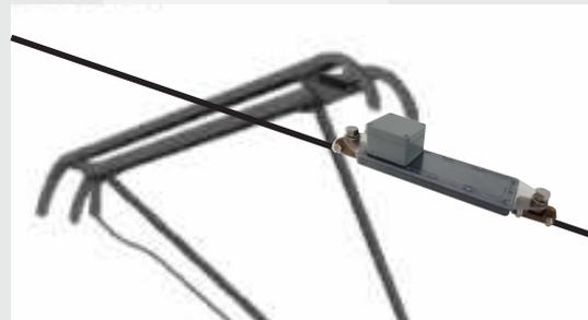
TramLD je induktivni (loop) detektor namenjen beskontaktnoj detekciji vozila javnog prevoza (tramvaja i trolejbusa). Predviđen je za montažu neposredno na vazdušni vod kontaktne mreže, posredstvom namenskih bakarnih klema. Detekcija prolaska tramvaja se vrši posredstvom detekcije prolaska pantografa referentnom zonom induktivne petlje.
